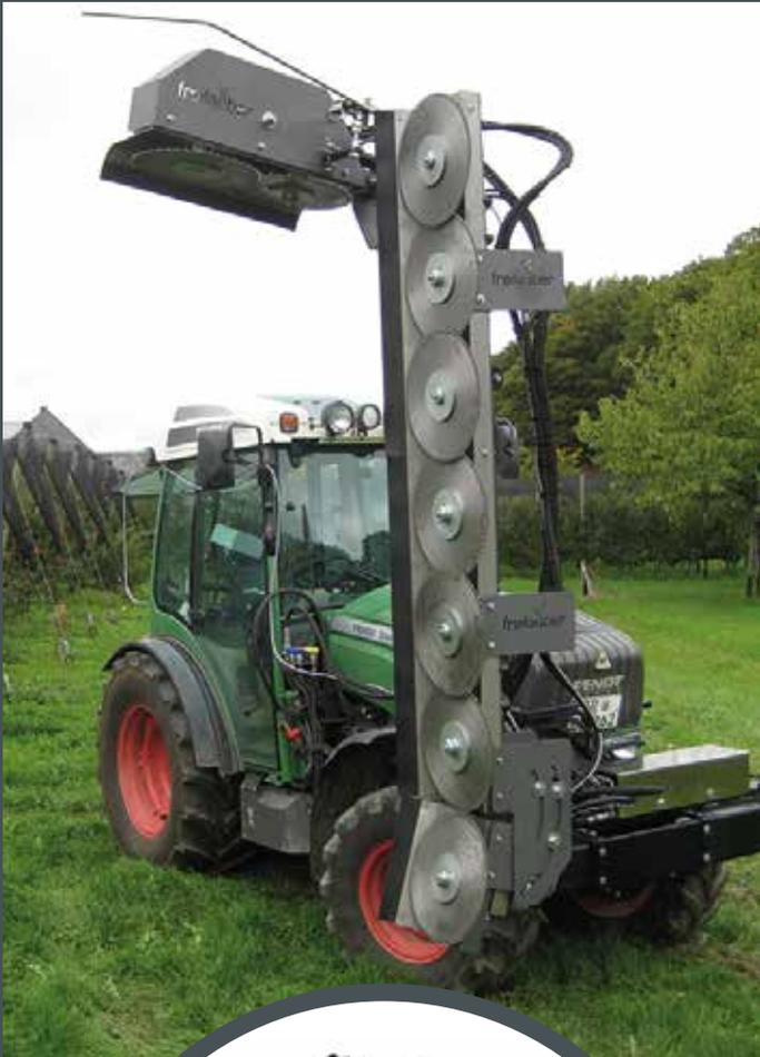
Der Obstbaumschneider Primus Kompakt ist standardmäßig mit einem mittleren Schneidmesser mit 6 Sägeblättern, sowie einem Kopfmesser mit 2 Sägeblättern ausgestattet.
