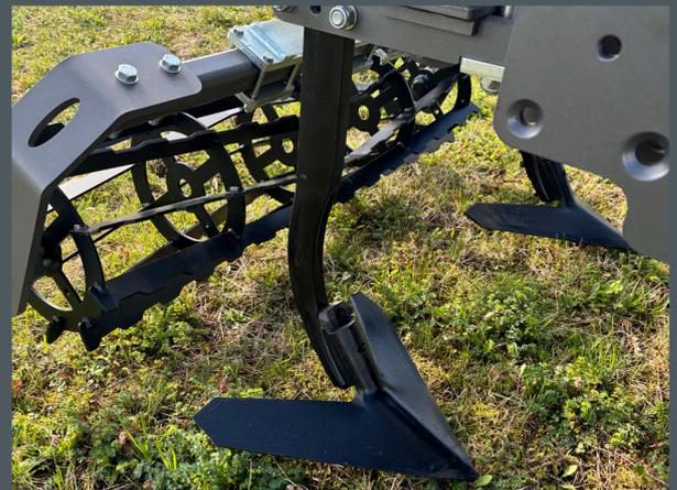
Socs à ailettes **à faible usure** avec système de changement rapide.
