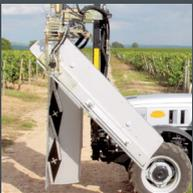
**Anfahrssicherungen** nach hinten, nach vorne und der Seite. **Alu-Spannleiste** für problemloses Nachspannen der Keilriemen und zusätzliche Stabilisierung des Schneidwerks.
