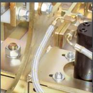
Ein **horizontales Messer** mit feststehender Achse und separatem Ölmotor sorgt für höchste Stabilität und Lebensdauer. Es sind keine Umlenkrollen erforderlich.
