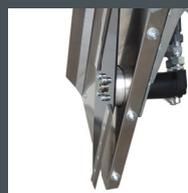
Je Schneidwerk ein **separater Motor** mit niedriger Drehzahl.
