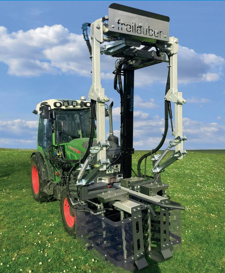
Zum Schutz des Gerätes sind alle vier Walzenträger mit einem Anfahrerschutzsystem ausgestattet. Die Walzenträger werden nach außen hin durch Federn in Position gehalten, sodass sie von krummen Stöcken nach außen gedrückt werden können, um Beschädigungen an Stock und Gerät zu vermeiden.
