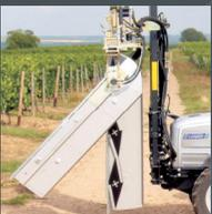
Montage très court. Pour ouvrir le capot, le bloc de valves peut être incliné vers l'avant. Aucun tuyau sur le capot.
