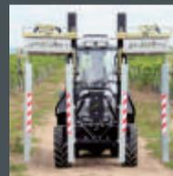
Bonne visibilité en position de transport car aucun tuyau et aucune valve dans le champ de vision.
