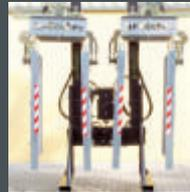
Pieds d'installation avec roues de guidage pour un montage et démontage faciles de l'appareil. La rogneuse est soulevée de la console avec la commande par joystick. Aucun cric ni chariot de manutention nécessaires.
