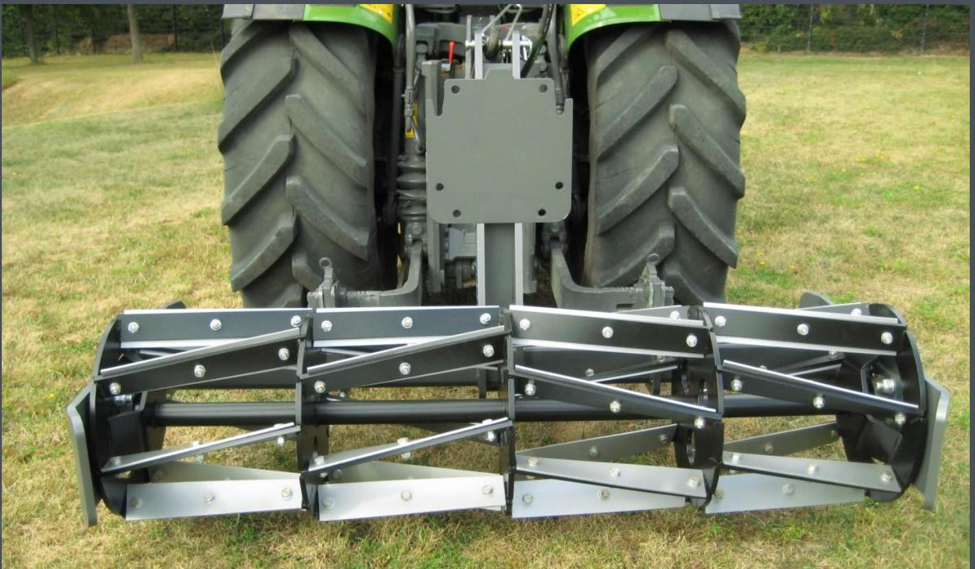
Die Messer des Muli sind schräg angeordnet und weisen eine gebogene Form auf. Somit ist der Schnitt einzigartig und liefert ein perfektes Ergebnis. Die Messer werden aus einem speziellen Stahl hergestellt und haben deshalb eine lange Standzeit. Durch das Drehen der Messer können diese ein zweites Mal eingesetzt werden.
