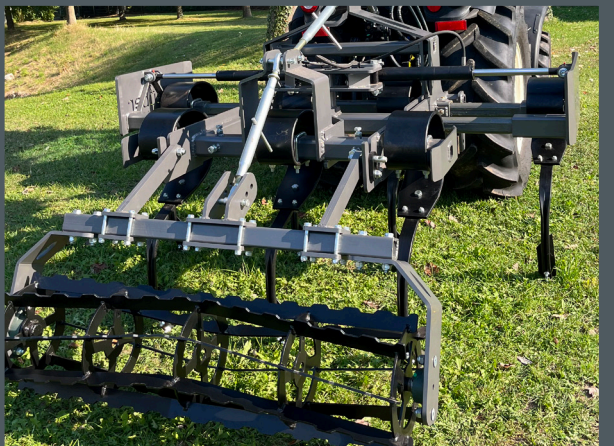
Mit Scharen, Breitenverschiebung .
