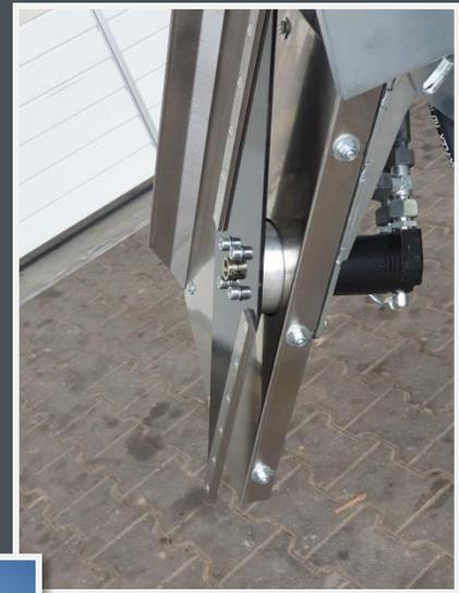
Je Schneidwerk ein separater Motor mit niedriger Drehzahl
