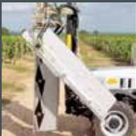
Protections anticollision sur l'arrière, le devant et le côté. Barre de serrage en alu pour un serrage sans problème des courroies trapézoïdales et stabilisation supplémentaire de l'unité de coupe.
