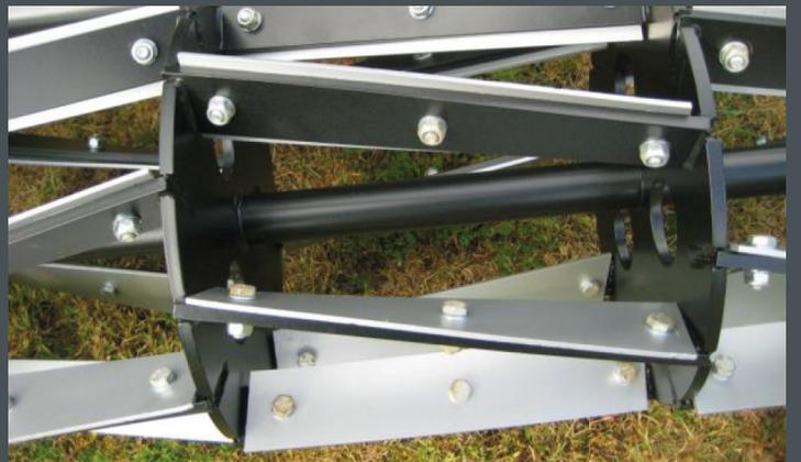
Les couteaux du Muli sont disposés en angle et ont une forme incurvée. Ainsi, la coupe est unique et offre un résultat parfait. Les couteaux sont en acier spécial et ont donc une longue durée de vie. En tournant les couteaux, ils peuvent être utilisés une second fois.
