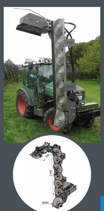
Par défaut, la tailleuse de fruitiers Primus Kompakt est équipée d'un couteau médian avec 6 lames de scie et d'un couteau de tête avec 2 lames de scie.
