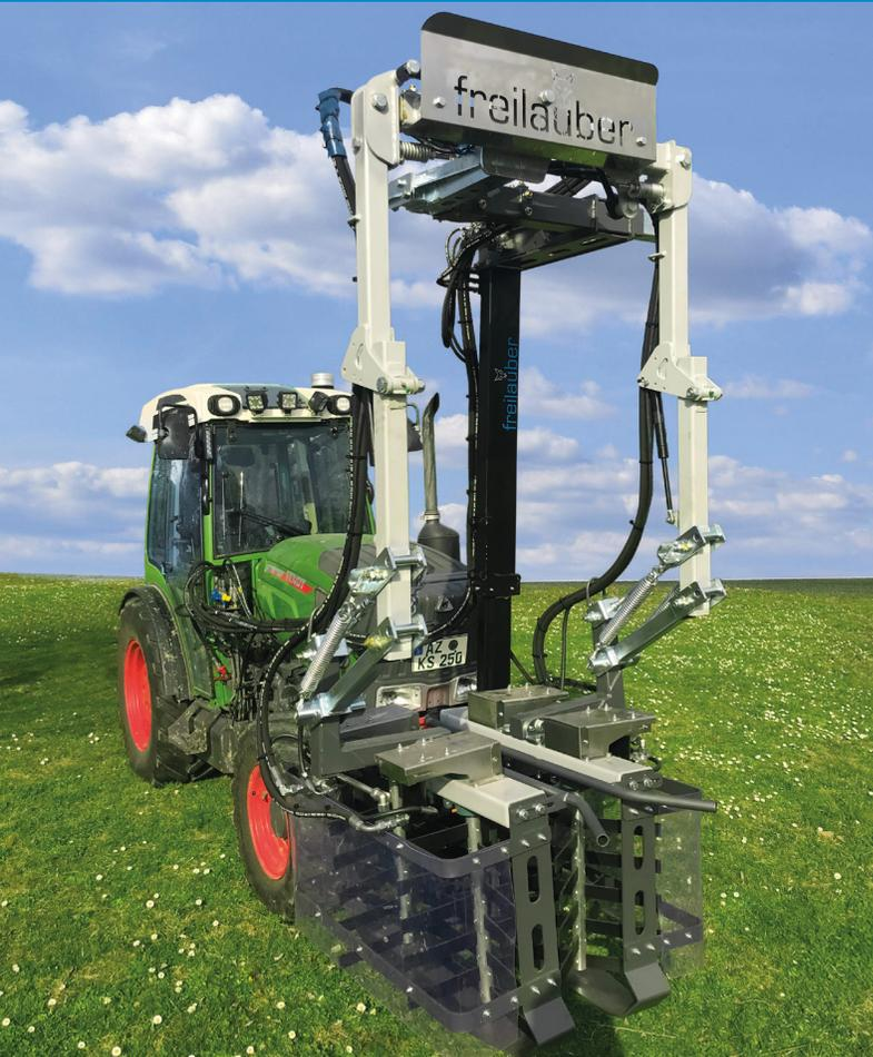
Pour protéger l'appareil, les quatre supports de rouleaux sont équipés d'un système de protection contre les chocs. Les supports de rouleaux sont maintenus en position vers l'extérieur par des ressorts, de sorte qu'ils peuvent être poussés vers l'extérieur par des ceps tordus, afin d'éviter d'endommager le cep et l'appareil.
